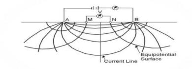
Figure 2.0: Schlumberger array (Wightman, et al., 2003).
